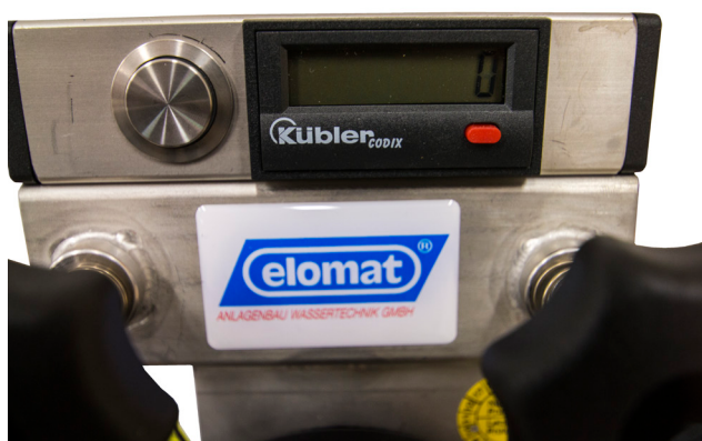
Elektronisk varvräknare, med nollställningsknapp.
